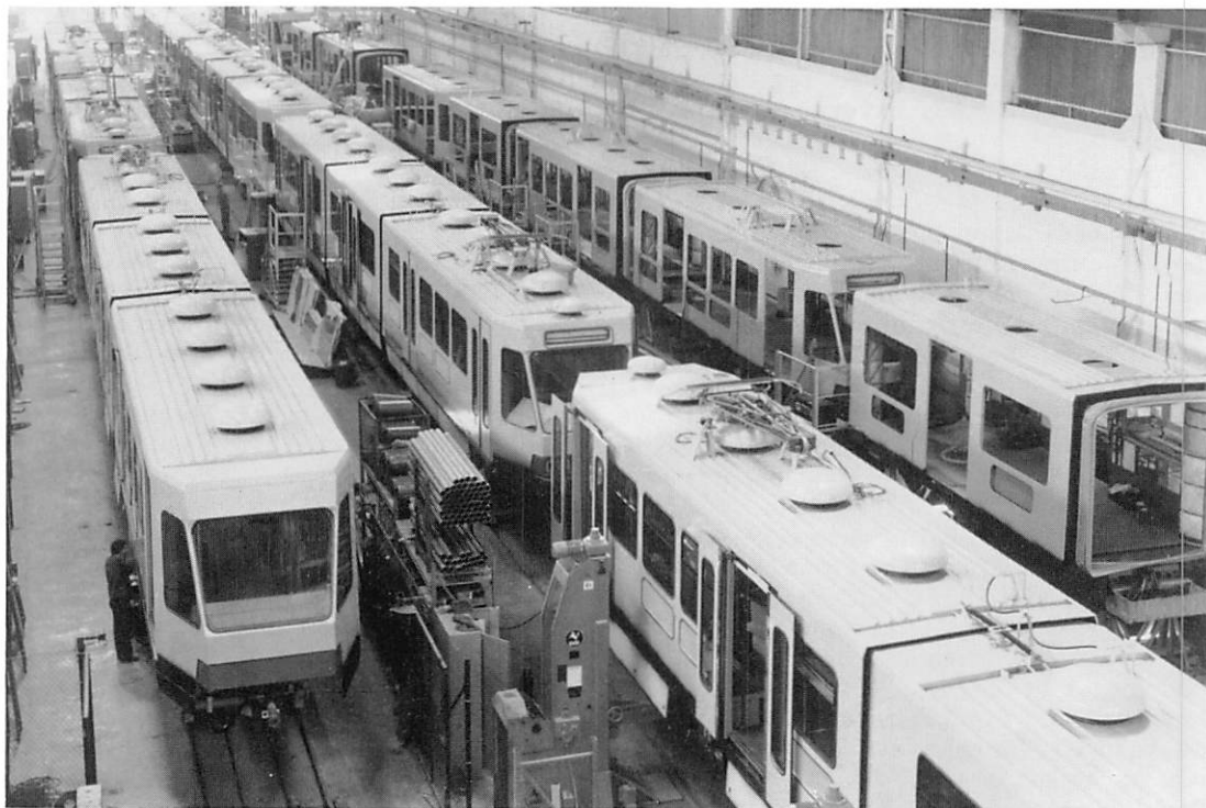
Chaîne de fabrication des véhicules de métro léger destinés au réseau urbain de Manille, aux Philippines, à l'usine "BN" à Bruges.
